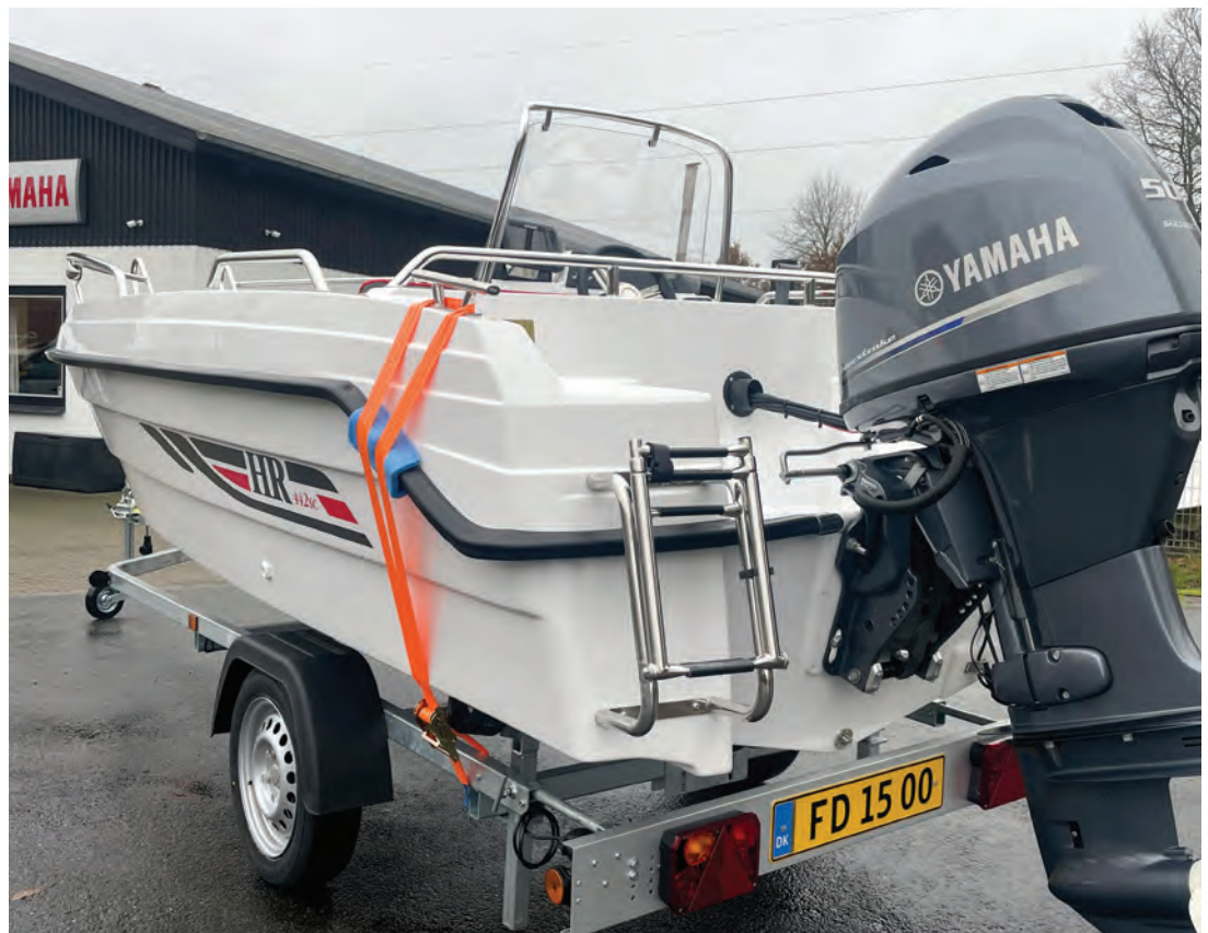
Korrekt lastet og sikret båt
