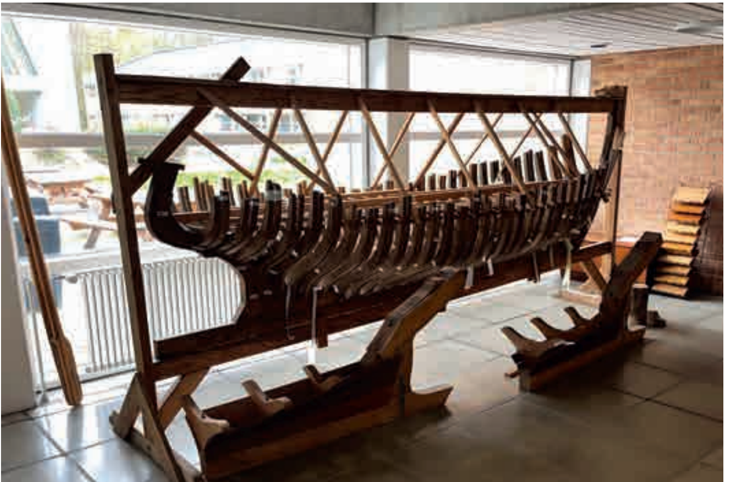
Danmarks største træ fiskekutter nedskalleret til en 3 meter lang model opbygget med køl og spanter
