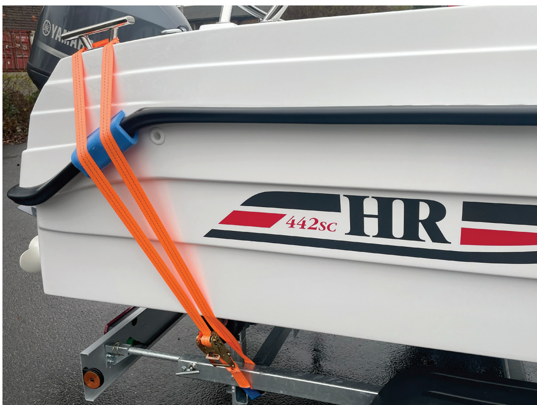
Stroppen er monteret, så båden ikke kan forskubbes bagud.
