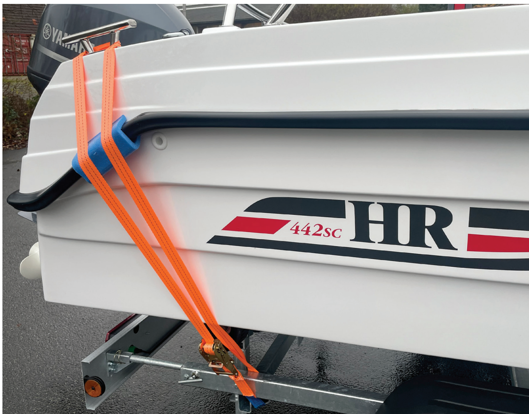
Stroppen er montert slik at båten ikke kan skli bakover
