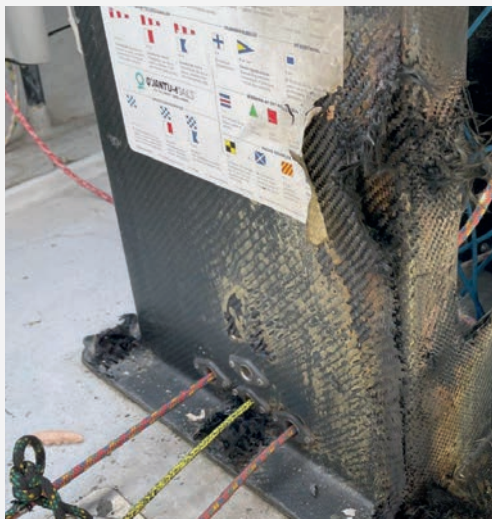
Varmeskadet konsol i cockpit
