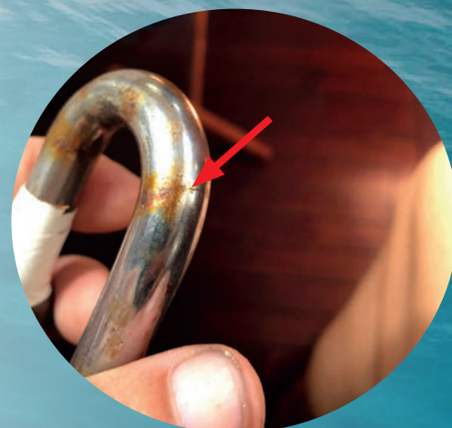
Bruddet starter alltid som små sprekker
