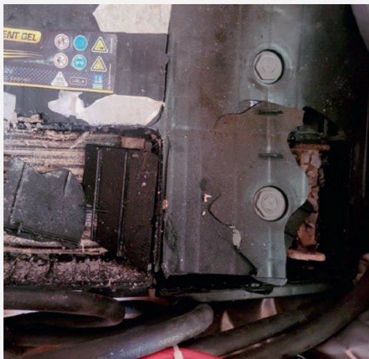
Overbelastning av batteri
